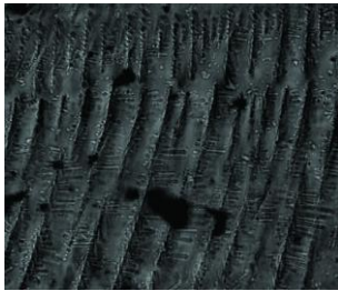
图 1 柱状雏晶的梳状结构 —, 500×
