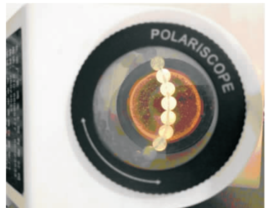
图4 偏光镜测试 Fig.4 Polariscope testing 图2b 样品, 结果为非均质集合体
